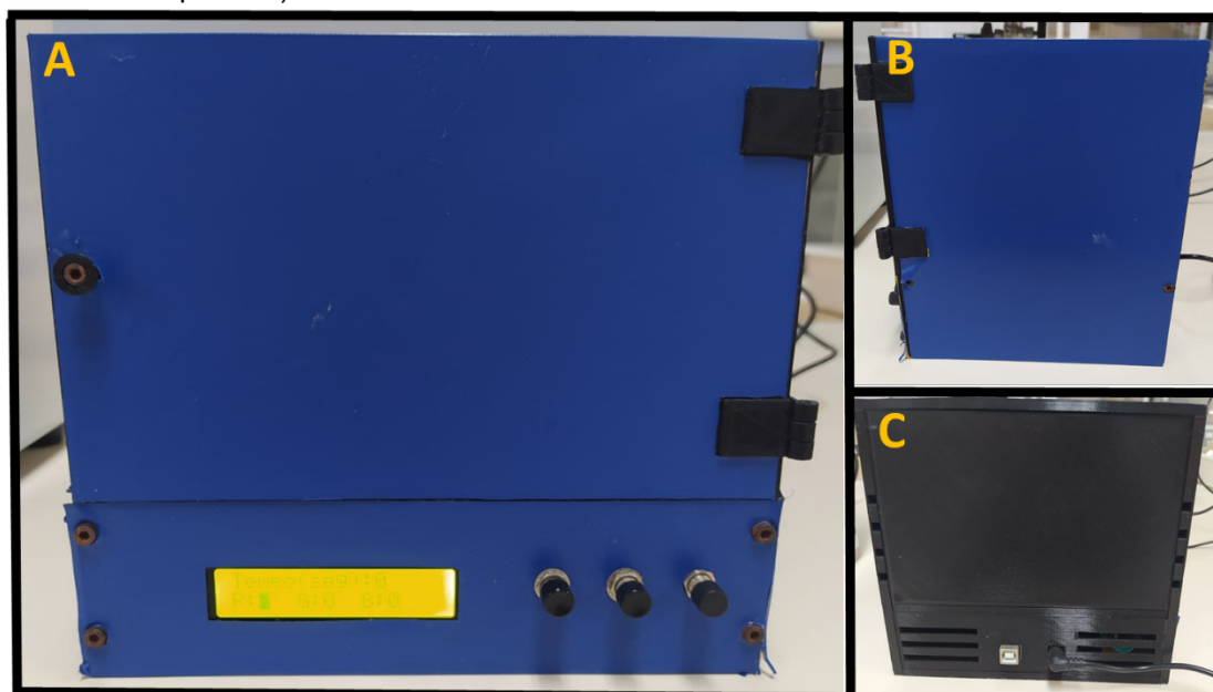
Figura 7: Visão externa do aparato. (A) Visão frontal, a interface com o usuário com três botões de comando (aumentar intensidade; diminuir intensidade; seletor) e painel em LCD. (B) Visão lateral e; (C) Visão traseira, com entrada de energia e porta USB para a programação (interface Arduino / Computador).
