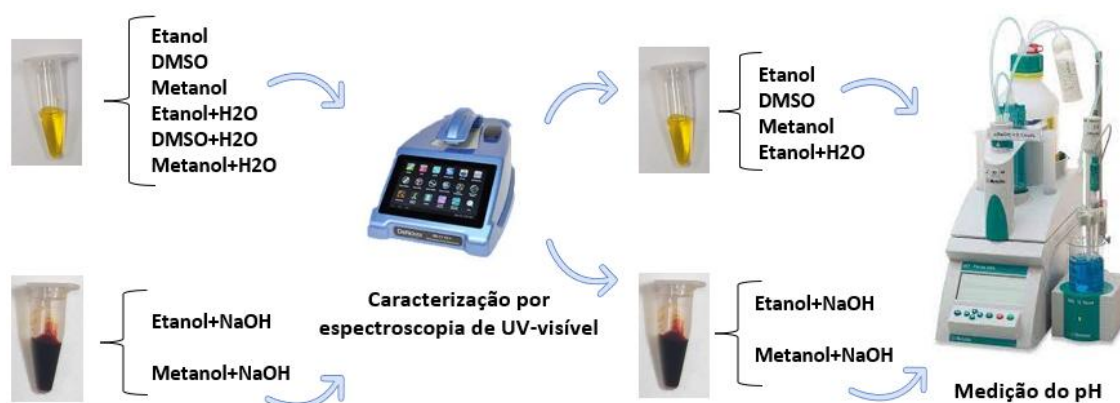
Figura 4: Esquema da metodologia utilizada no estudo da diluição da curcumina
