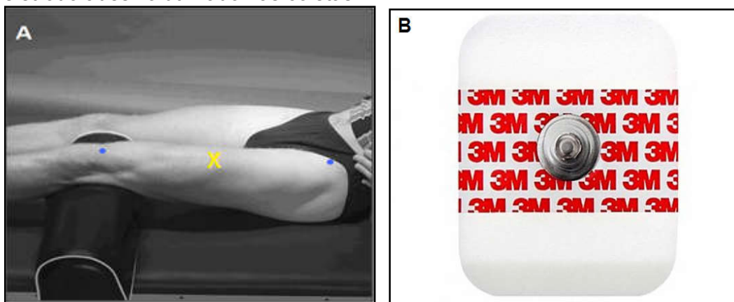
Figura 03: Local de fixação dos eletrodos, segundo SENIAM e demonstrativo do eletrodo adesivo utilizado nas coletas.
