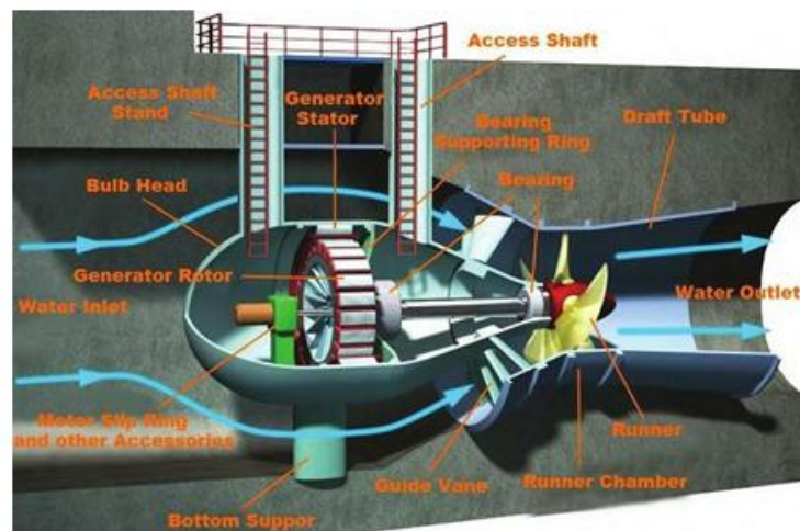
Figura 17 - Turbina Bulbo
