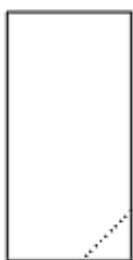
Figura A.6 - Tipo F - Fraturas no topo e/ou na base do capeamento
