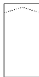
Figura A.7 - Tipo G - Similar ao tipo F - com fraturas próximas ao topo
