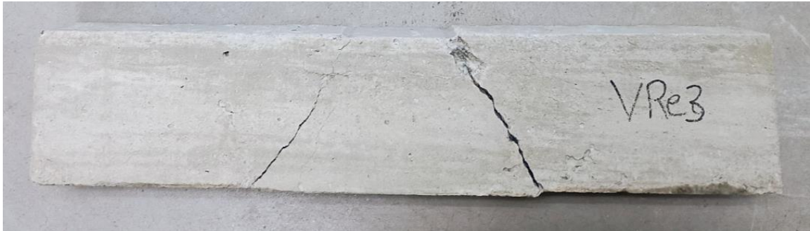
Figura 45. Viga com reforço Vre03
