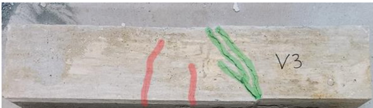
Figura 39. Viga sem reforço V03
