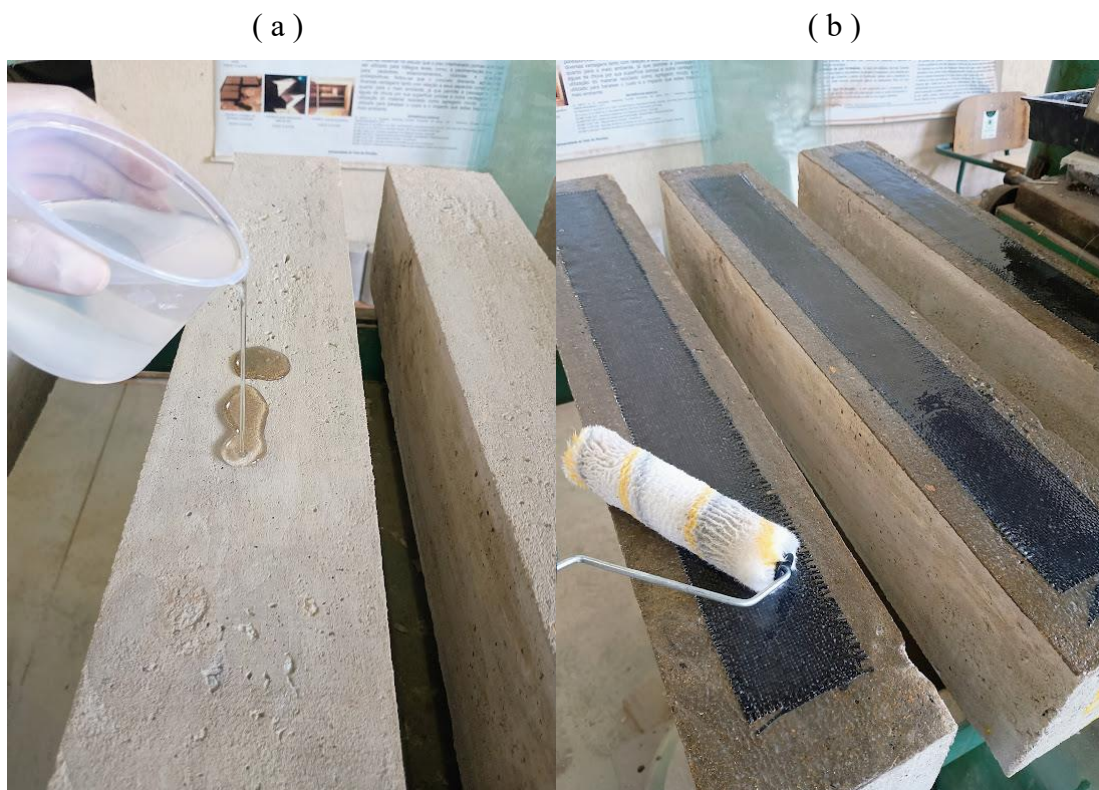
Figura 25. Etapas de aplicação de resina no substrato e aplicação do tecido de fibra de carbono
