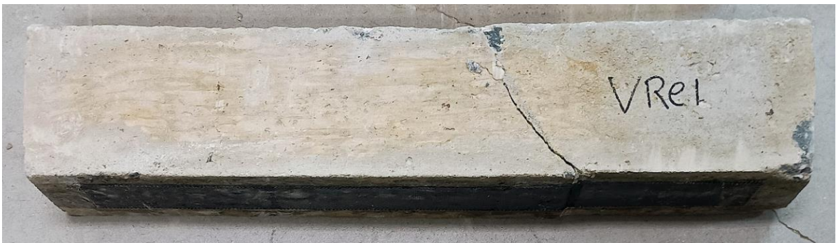
Figura 41. Viga com reforço Vre01
