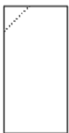
Figura A.6 - Tipo F - Fraturas no topo e/ou na base do capeamento
