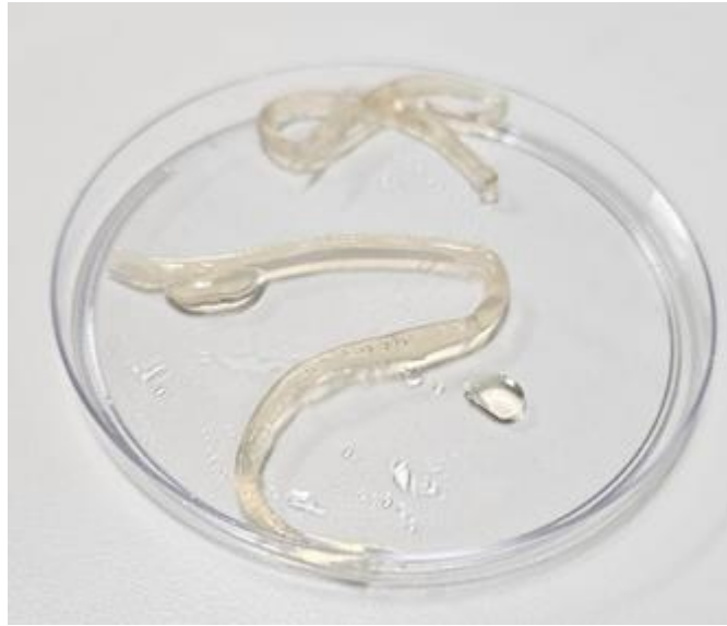
Figura 44 – Filamento produzido manualmente com sistema de seringas em T.
