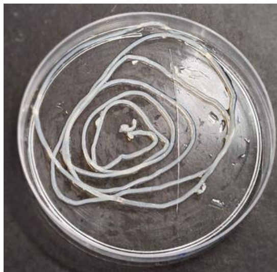
Figura 46 – Filamento produzido utilizando o bico de coextrusão projetado e construído, acionando as seringas manualmente.
