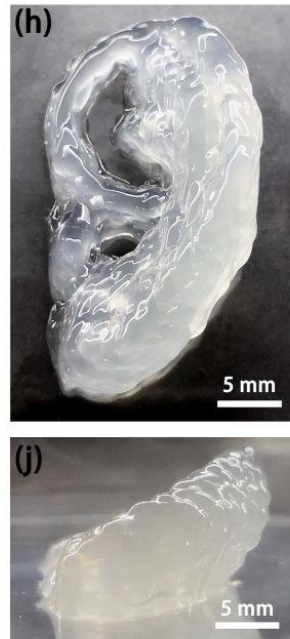
Figura 5 – Impressão de Ni et al. com hidrogéis de SF/HPMC-MA.
