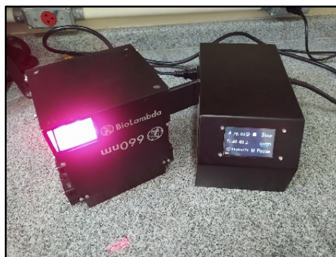
Figura 12 - Caixa de diodo emissor de luz vermelha (LED) em funcionamento.
