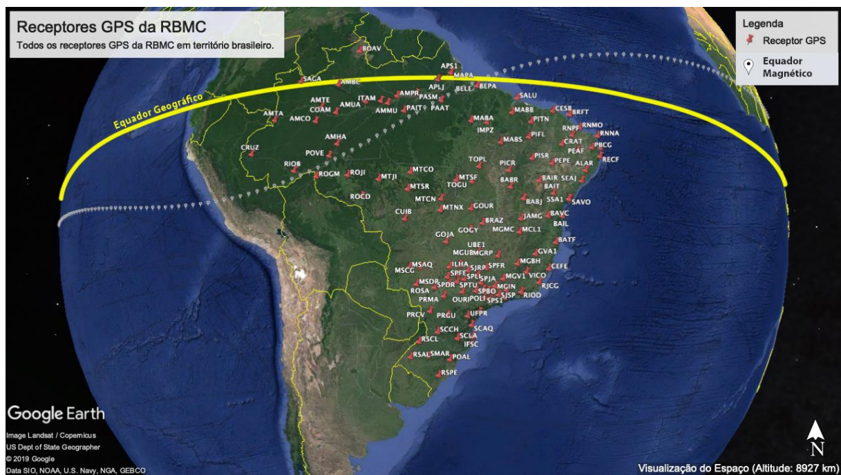
Figura 19 - Distribuição das estações GPS-TEC pertencentes a RBMC em território brasileiro. Destaque para pontilhado branco que indica o caminho do equador magnético.
