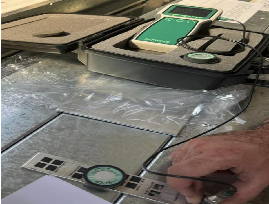
Figura 14 - Medição de condutividade elétrica das barras revestidas com grafite.
