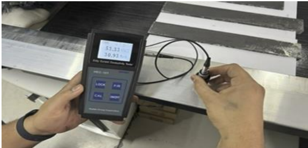
Figura 16 – Exemplo de medição de condutividade elétrica das barras revestidas com grafeno.
