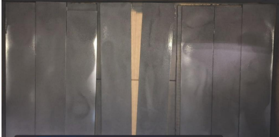
Figura 12 – Barramento após o tratamento com grafeno.
