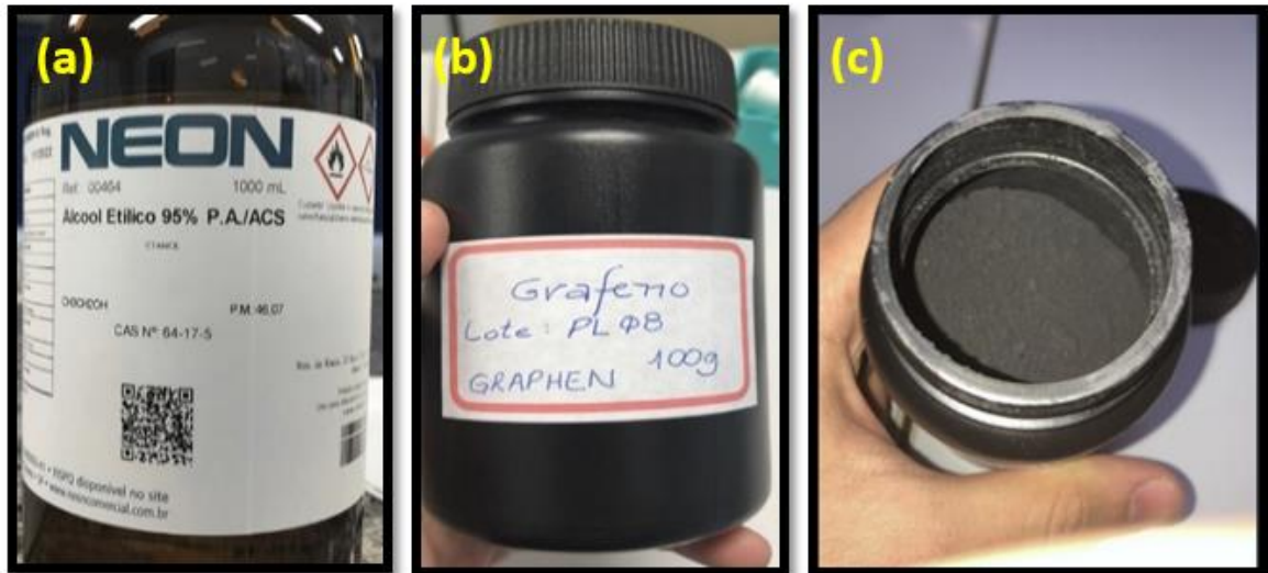
Figura 15 – Insumos utilizados para aplicação superficial do grafeno.
