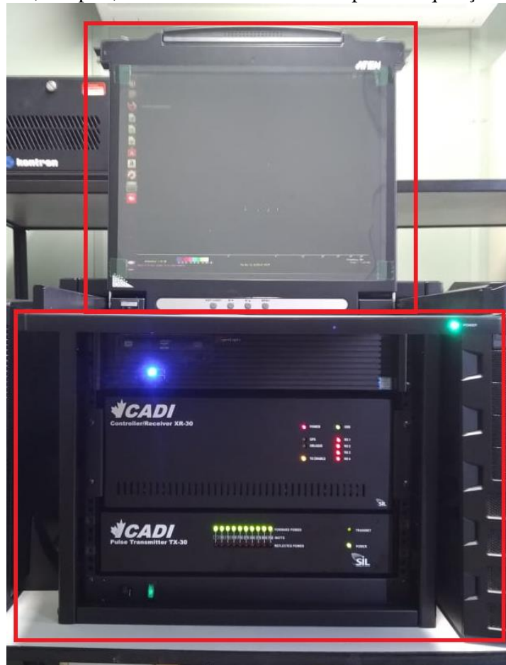
Figura 23 - Equipamentos internos da ionossonda digital CADI instalada em SJC, destacados pelos retângulos vermelhos. O sistema é composto pelo computador, gerador de frequência, transmissor, receptor, sistemas de controle de tempo e de aquisição de dados.
