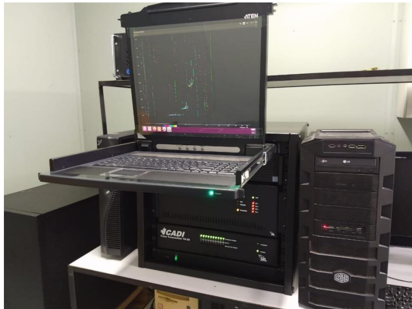
Figura 10: CADI sendo utilizada juntamente com um computador para o monitoramento dos dados ionosféricos em São José dos Campos.
