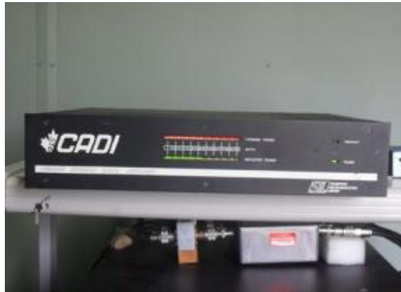
Figura 7: Sistema de transmissão da ionossonda digital CADI para amplificação dos sinais de rádio do grupo de Física e Astronomia da UNIVAP.
