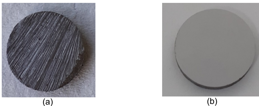
Figura 23: Imagem do substrato de aço carbono a) amostra bruta, b) amostra pré-tratada.
