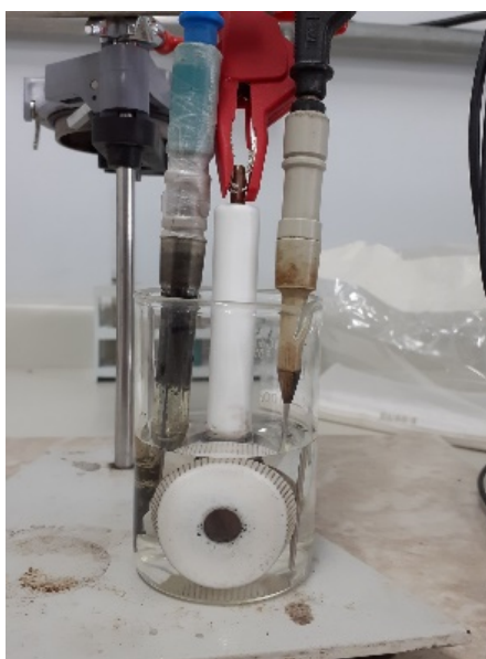
Figura 22: Célula de três eletrodos utilizada nos ensaios eletroquímicos
