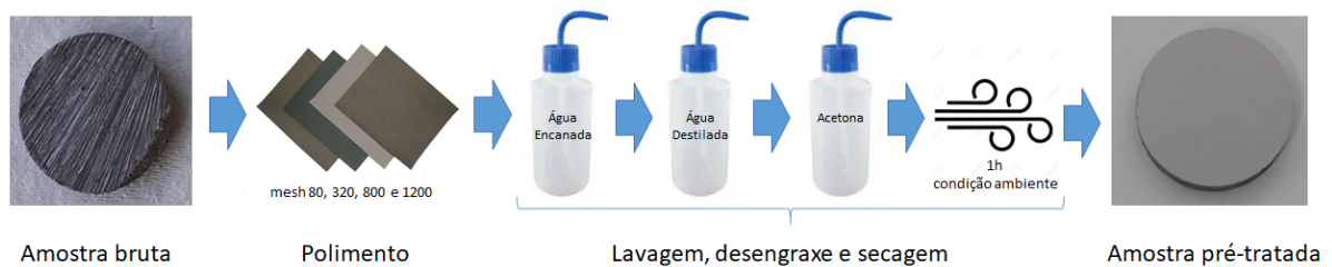
Figura 19: Etapas do pré-tratamento das amostras do substrato metálico.
