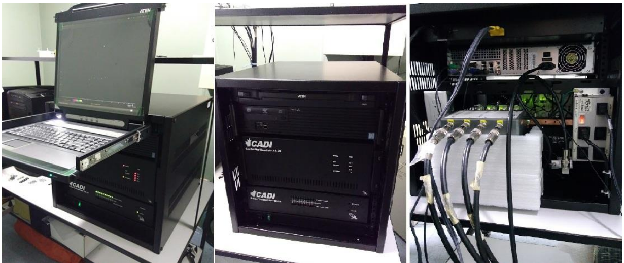
Figura 26 – Sistema de transmissão e recepção da ionossonda digital CADI.
