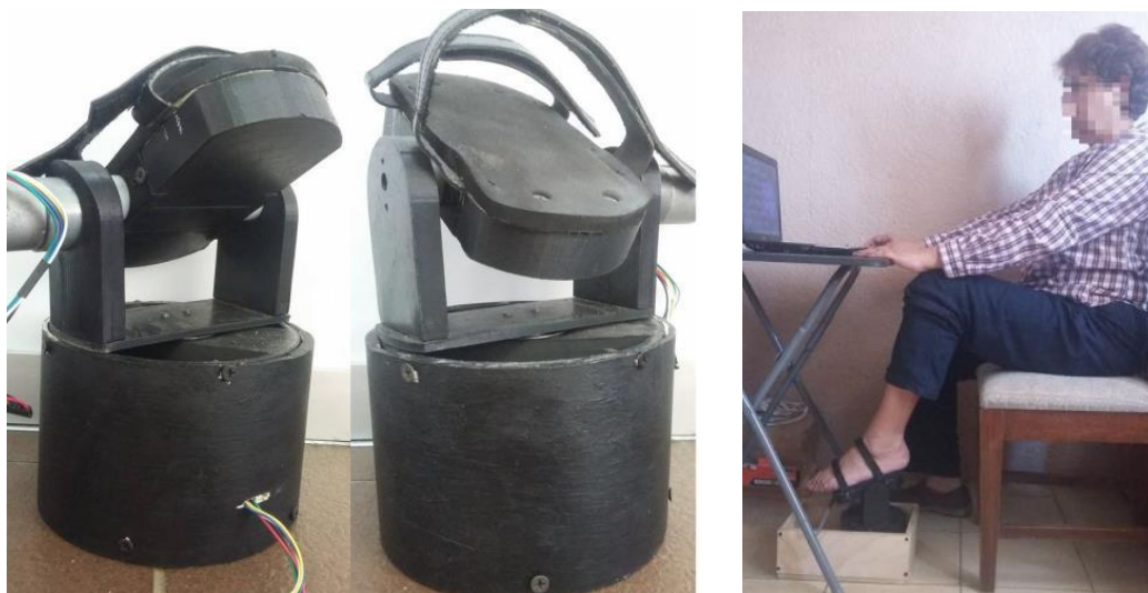
Figura 7 – Suporte robótico para reabilitação de tornozelo desenvolvido com Arduino.
