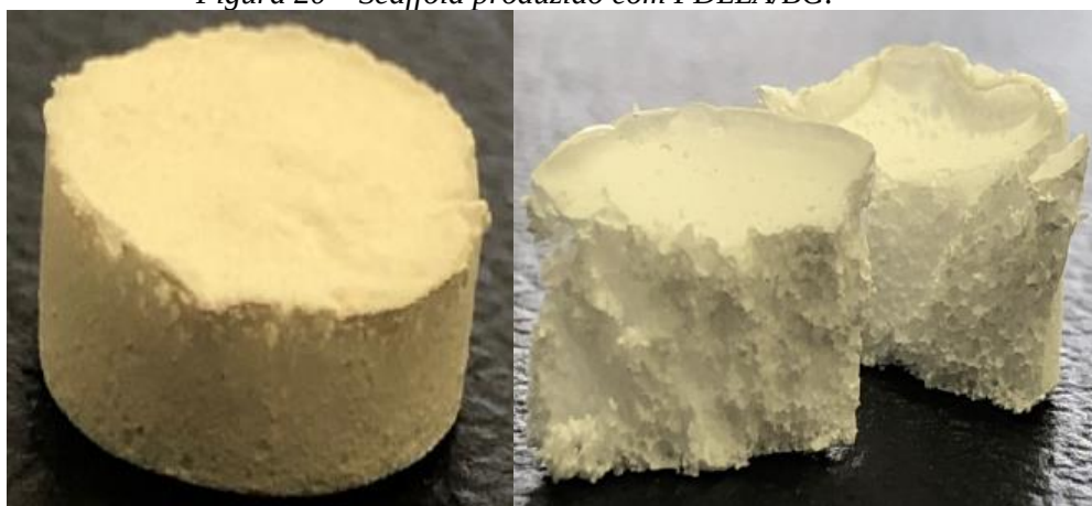
Figura 20 – Scaffold produzido com PDLA/BG.
