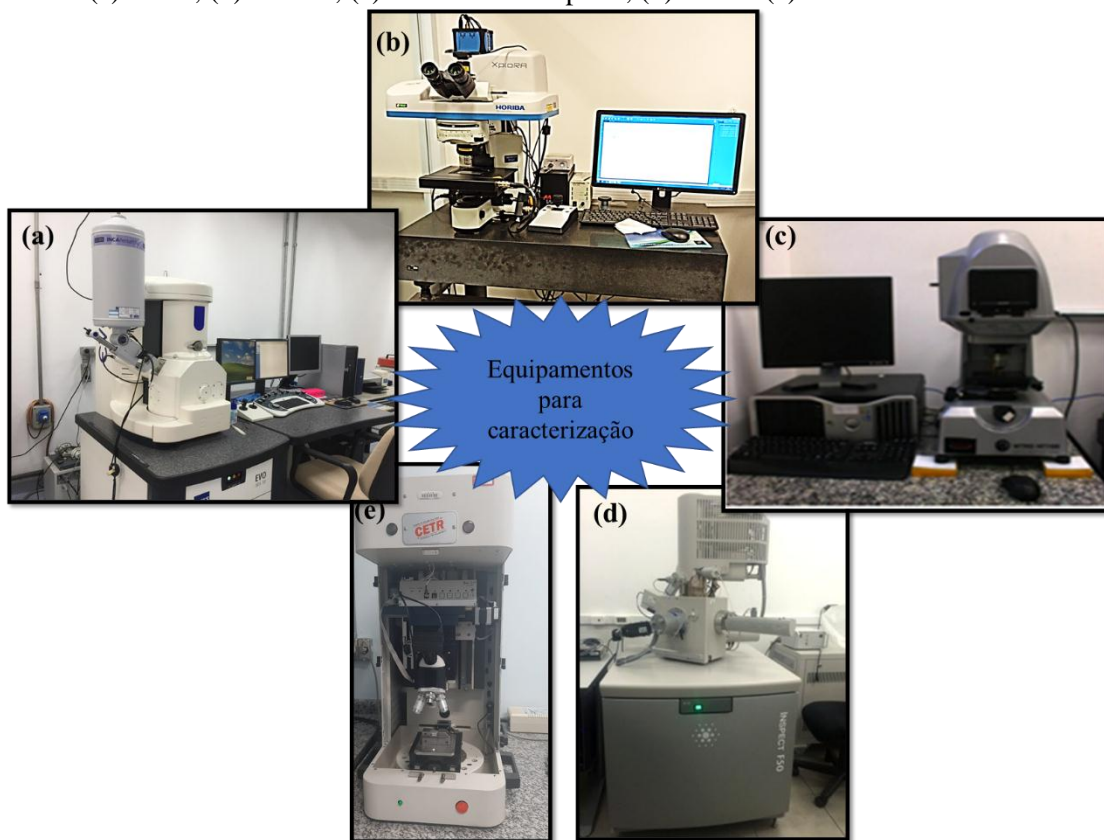
Figura 14 - Imagens dos equipamentos utilizados no processo de caracterização dos filmes e revestimentos: (a) MEV; (b) Raman; (c) Perfilmetro Óptico; (d) FEG e (e) Tribômetro.
