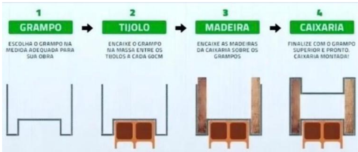
Figura 5 – Esquema de montagem do grampo na estrutura.
