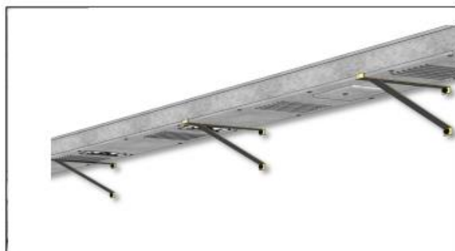
Figura 8: Mão-francesa, através de suportação na parede e atracamento lateral
