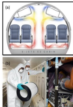
Figura 8 - Sistema de Ventilação da Aeronave (a). Manutenção de um filtro HEPA em aeronave da Emirates (b).
