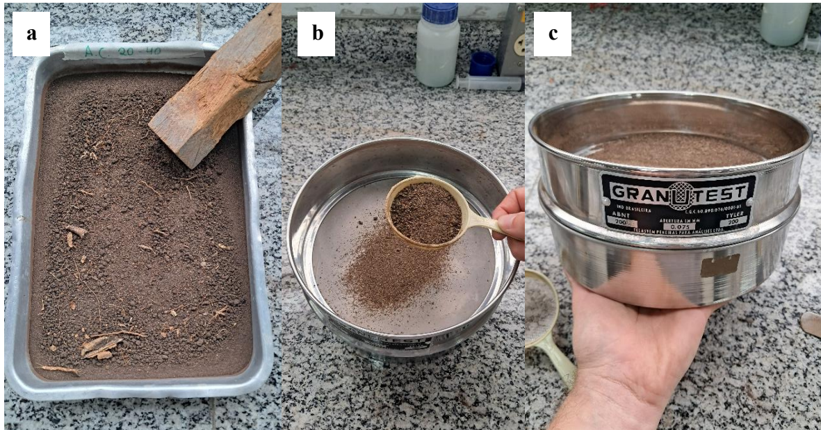
Figura 5 - Beneficiamento das amostras de solo, destorroamento (a), peneiração em peneira comercial de maior abertura (b) e peneiração em peneira Granutest de menor abertura (c).
