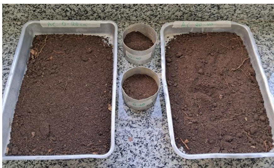
Figura 4 - Amostras de solo do local em estudo de 0-20cm (esquerda) e de 20-40cm (direita) de profundidade.
