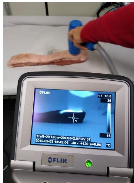
Figura 8: Imagem ilustrativa da aplicação da radiofrequência nos corpos de prova
