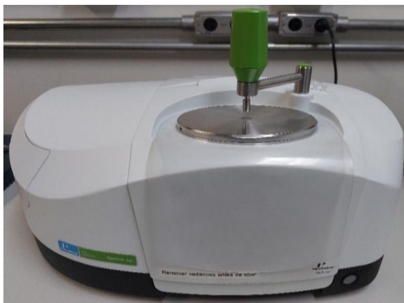
Figura 10: Espectrofotômetro Spectrum Two aberto com o UATR, sendo ambos da PerkinElmer.
