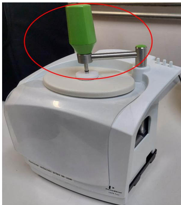
Figura 9: Acessório UATR Diamante/ZnSe (reflexão única) para o Spectrum Two da PerkinElmer.
