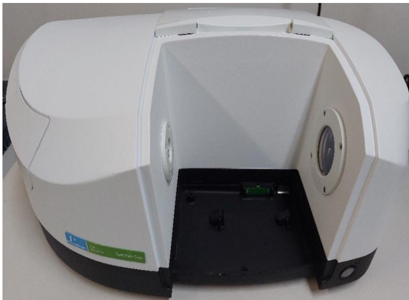
Figura 8: Espectrofotômetro Spectrum Two da PerkinElmer aberto sem o UATR.
