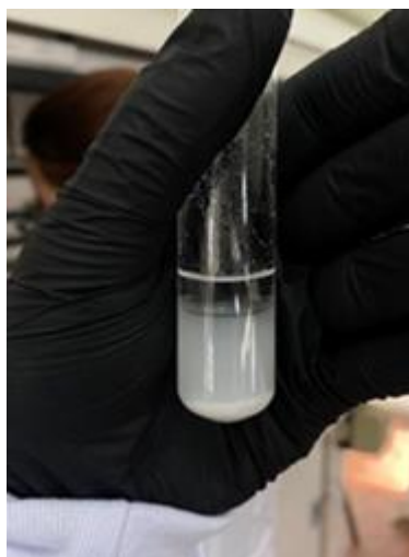
Figura 35: Amostra depois da adição de hexano e água destilada.
