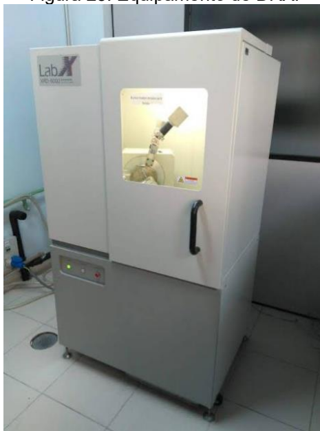
Figura 25: Equipamento de DRX.
