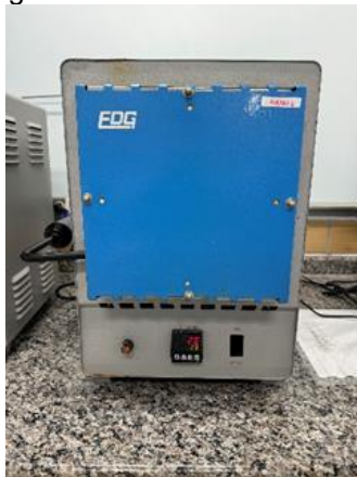
Figura 22: Mufla FGD utilizada.
