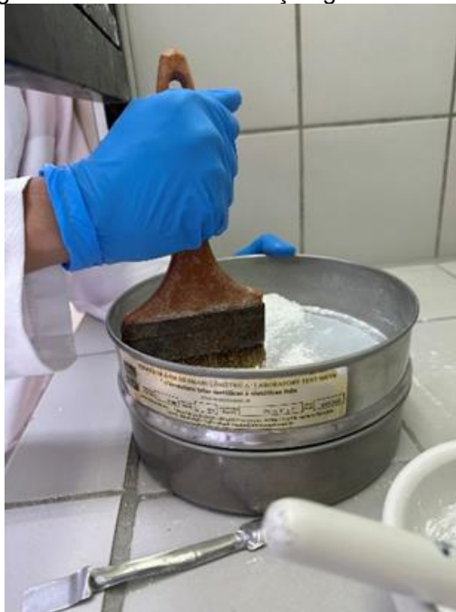
Figura 21: Processo de seleção granulométrica.
