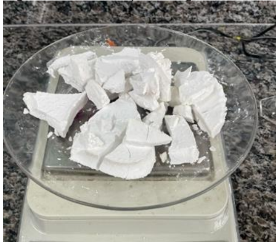
Figura 18: Resíduo após secagem em estufa.
