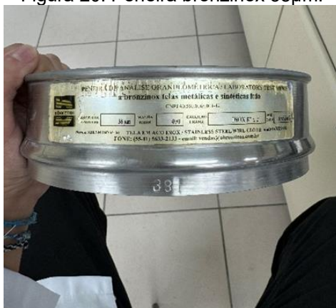
Figura 20: Peneira bronzinox 38 \mu m.
