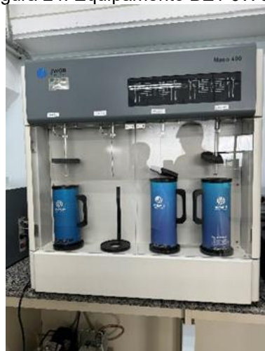
Figura 24: Equipamento BET JWGB.
