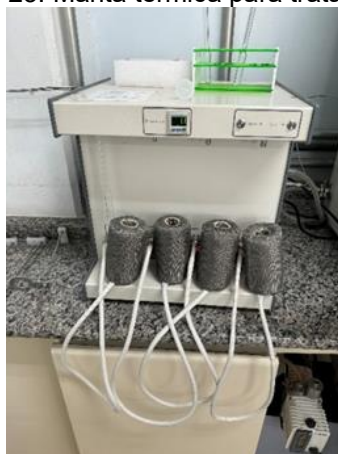
Figura 23: Manta térmica para tratamento.
