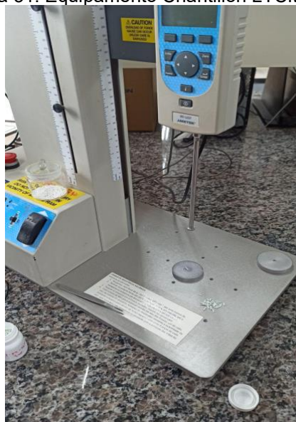
Figura 31: Equipamento Chantillon LTCM- 100.
