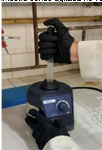
Figura 33: Amostra sendo agitada no vórtex.
