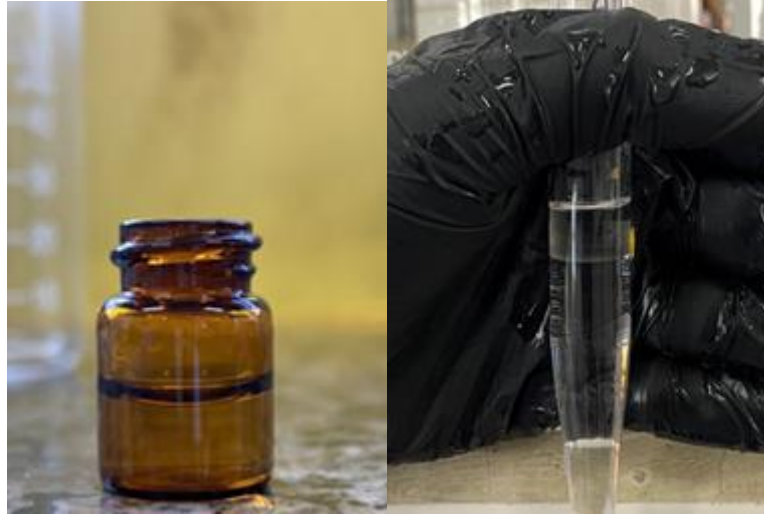
Figura 36: Amostra após centrifugação e \frac{2}{3} coletado.
