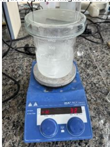
Figura 13: Dissolução e agitação magnética do hidróxido de sódio.
