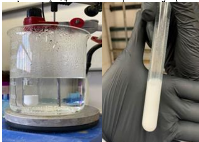
Figura 34: Adição da solução de \text{H}_2\text{SO}_4 em metanol e posterior agitação no vórtex e banho maria.
