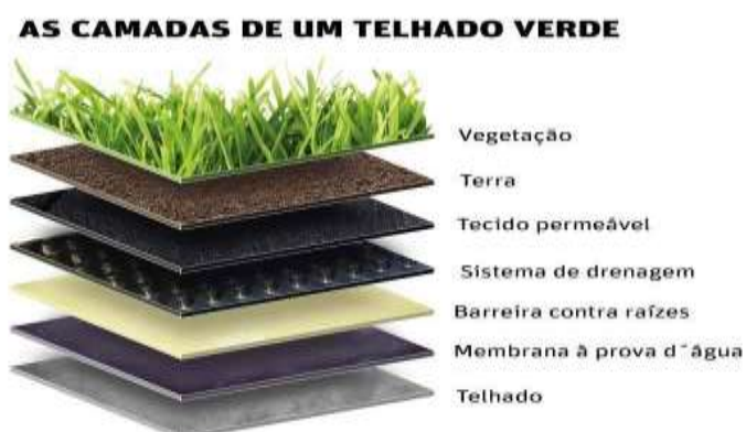
Figura 20 – Modelo das camadas de um telhado verde.
