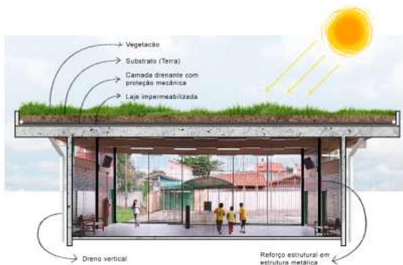
Figura 21 – Protótipo digital destacando a vista interna do pátio principal da Escola E.E.E.M.I. Nelson do Nascimento Monteiro, com instalação do teto verde.
