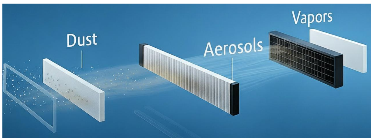
Figura 18 - Representação esquemática da filtração de partícula.
