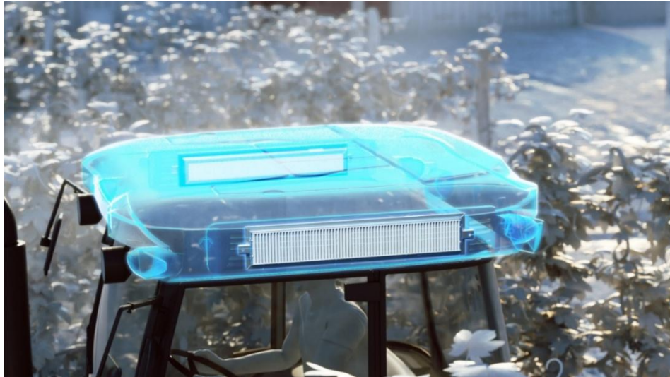
Figura 8 - Simulação digital do sistema de filtragem instalado no teto da cabine de trator agrícola.
