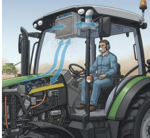
Figura 13- Sistema de Filtração de Cabine em Trator Agrícola
