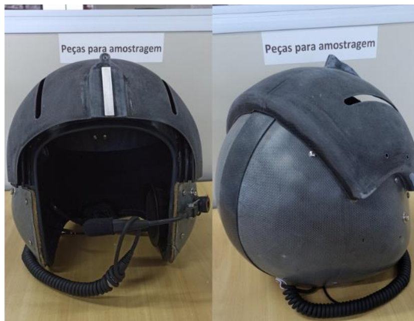
Figura 23 – Novo modelo com a proteção do protótipo de compósito de carbono e Kevlar®.
