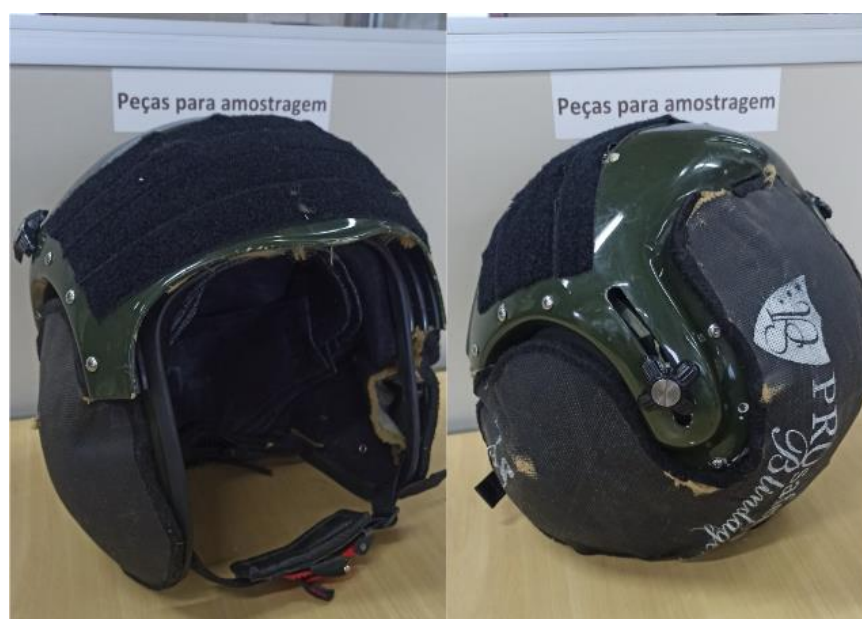
Figura 11 – Capacete 2 com dupla proteção nível IIIA de Kevlar® puro (após os tiros).
