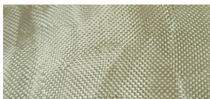
Figura 3 - Imagem de uma amostra de manta de fibra de kevlar®.
