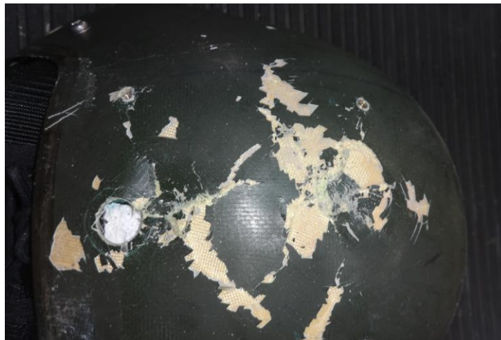
Figura 2 – Imagem do capacete após impactos de tiros em proteção balística sobre seu casco.
