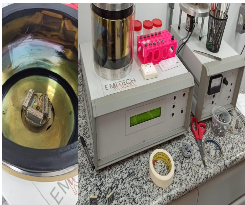
Figura 9 – Amostras após a pulverização do ouro e o equipamento Emitech K550X .
