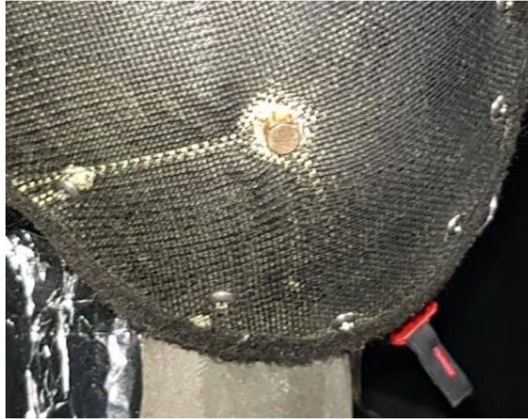
Figura 21 - Projétil retido na lateral do capacete após disparo nos testes.
