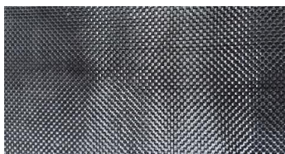
Figura 5 – Imagem de uma manta de fibra de Carbono.
