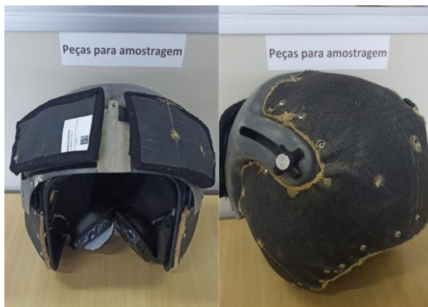
Figura 10 - Capacete 1 com dupla proteção nível IIIA de Kevlar® puro (após os tiros).
