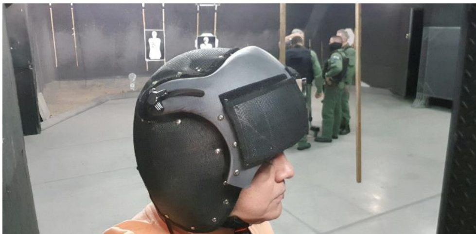
Figura 12 - Capacete 1 com dupla proteção nível IIIA de Kevlar ® puro no estande de tiro.
