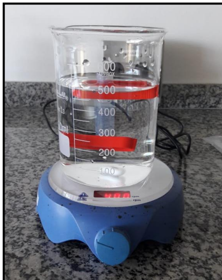
Figura 8: Processo de diálise do Complexo Gd DTPA-Cisteamina.
