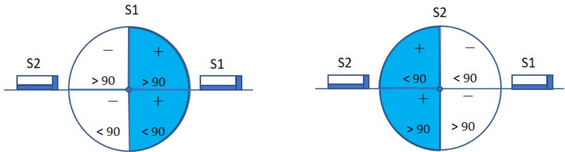
Figura 17-Diagrama com posições do sensor por quadrante
