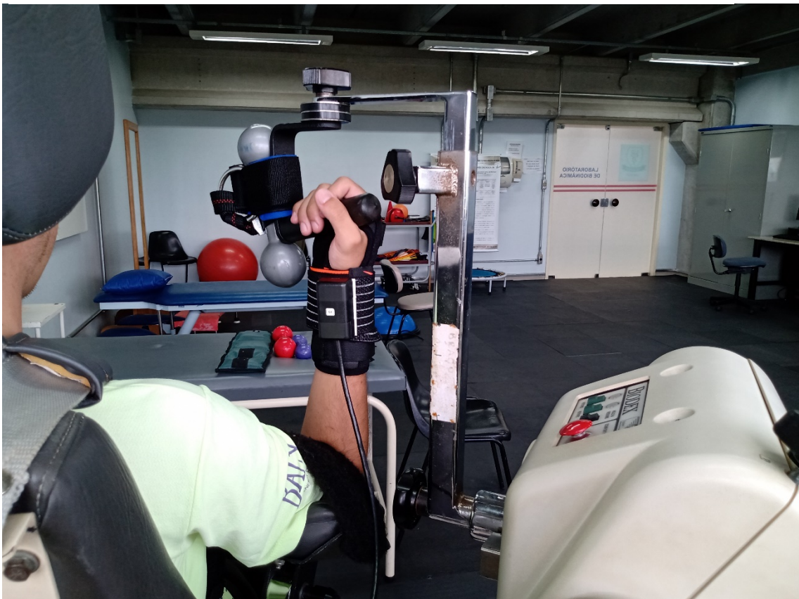
Figura 41- Posicionamento do voluntário no Dinamômetro Isocinético
