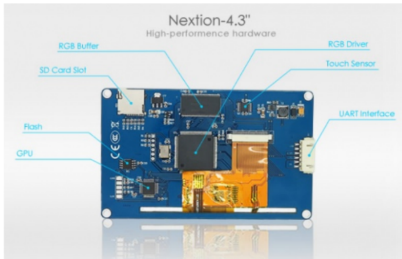
Figura 7 - Display vista traseira
