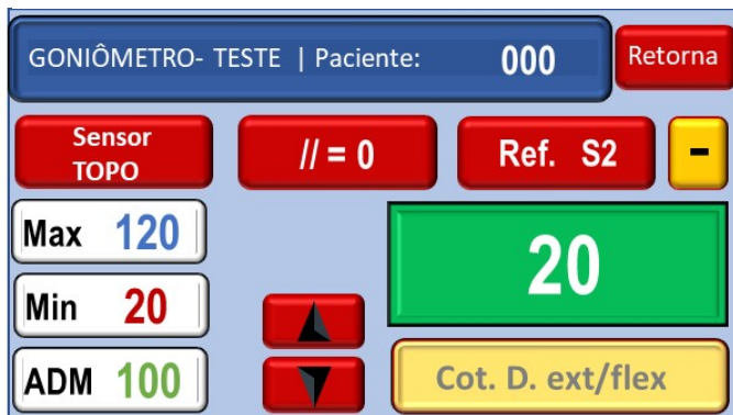
Figura 58- Armazenamento ângulo mínimo e ADM na memória
