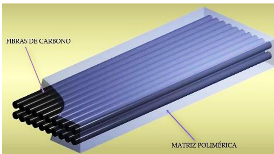
Figura 3 – Representação esquematizada de um compósito polimérico reforçado com fibra de carbono.
