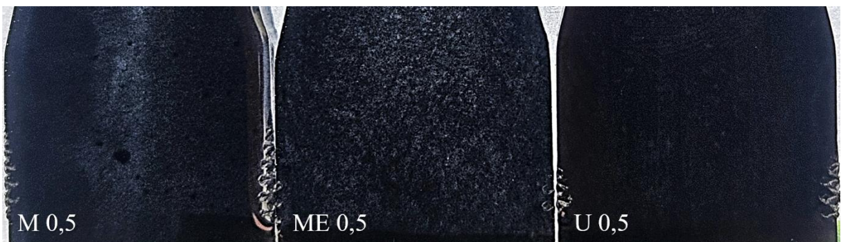
Figura 17 – Fotografias dos nanocompósitos contendo 0,5% em massa de GNP para os diferentes processos de mistura: agitação manual (M), agitação mecânica (ME) e por ultrasonicação (U).
