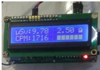
Figura 6 - Teste com a Placa Arduino Geiger montada
