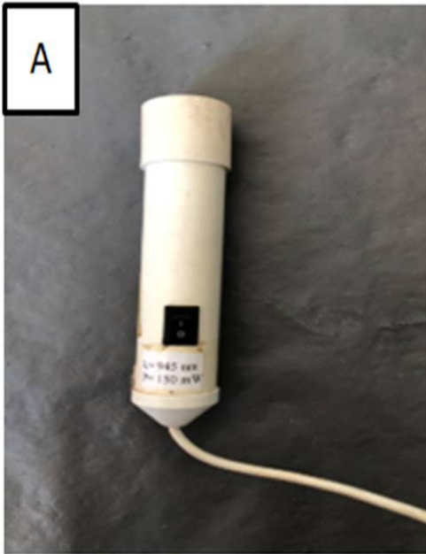
Figura 7- Imagens ilustrativas do Protótipo de LED (945 nm) usado na pesquisa (A) e do colimador (B).
