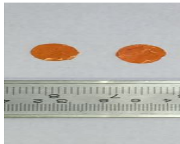
Figura 5- Amostras da Membrana de Poliestireno, Colágeno e Norbixina (MPSCN) utilizada no estudo.
