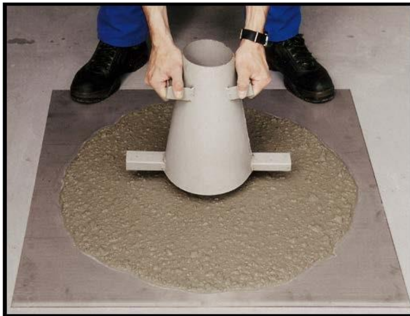
Figura 2: Ensaio de espalhamento slump flow .
