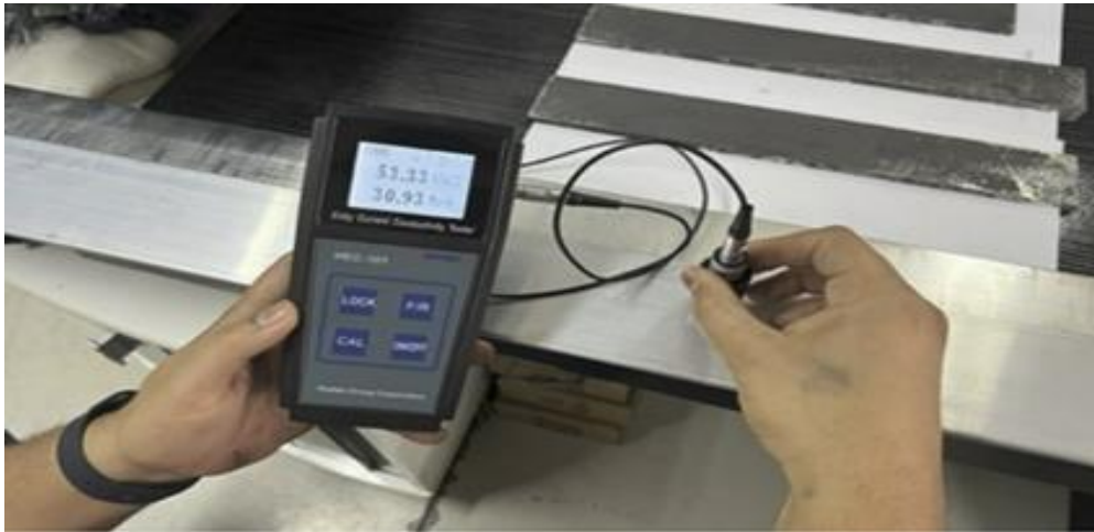
Figura 7 – Exemplo de medição de condutividade elétrica das barras revestidas com grafeno
