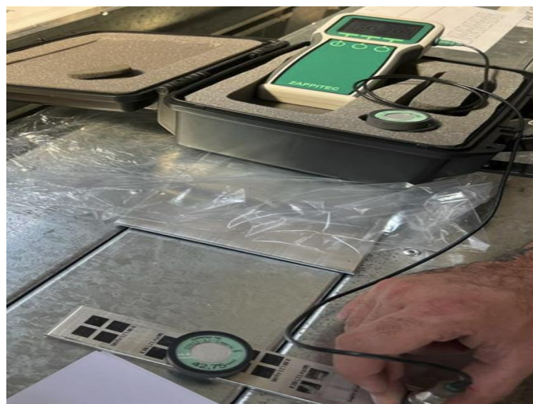
Figura 6- medição de condutividade elétrica das barras revestidas com grafite.
