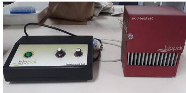
Figura 2: Equipamento utilizado para irradiação das placas de cultura celular.
