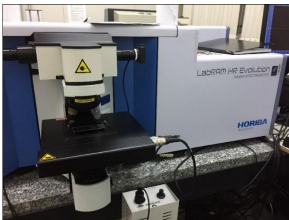
Figura 19 - Equipamento de Espectroscopia Raman – Modelo Labram HR Evolution .
