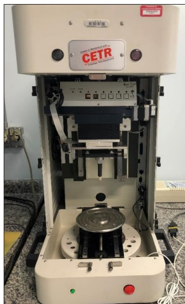
Figura 24 - Tribômetro do modelo Ultra Micro UMT2, Bruker.
