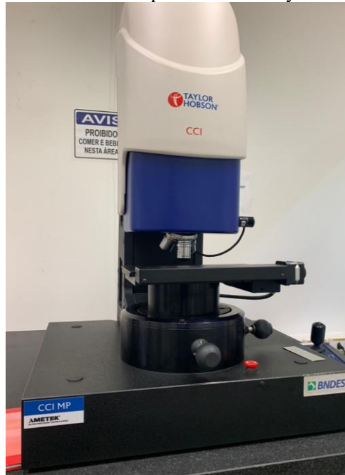
Figura 23 - Perfilômetro óptico modelo Taylor Hobson inc.
