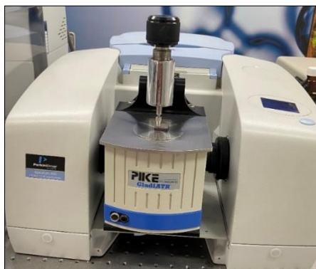
Figura 20 - Equipamento FT-IR do modelo Spectrum 400 FT-IR da Perkin-Elmer.
