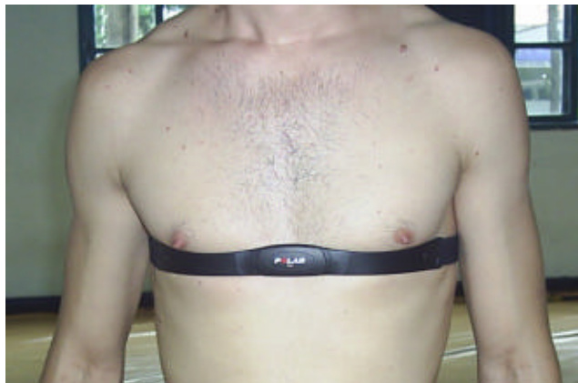
Figura 7: Sensor WearLink® e Monitor Cardíaco Polar S810i® posicionado no tórax para captação do intervalo RR. Fonte: Arquivo pessoal.
